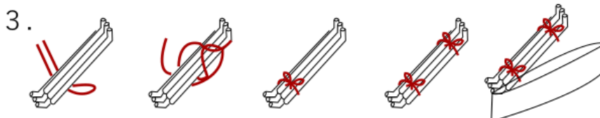
ロープを半分に折り 部品の下を通す
